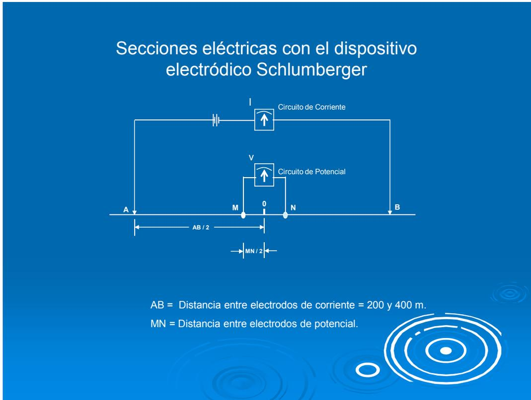
Figura 14. Diagrama de la configuración electródica Schlumberger, utilizada para la realización de las secciones y sondeos eléctricos verticales (SEVs). Las aberturas máximas de los SEV's fueron de  $AB/2$  de 1500 y 2000 m.
