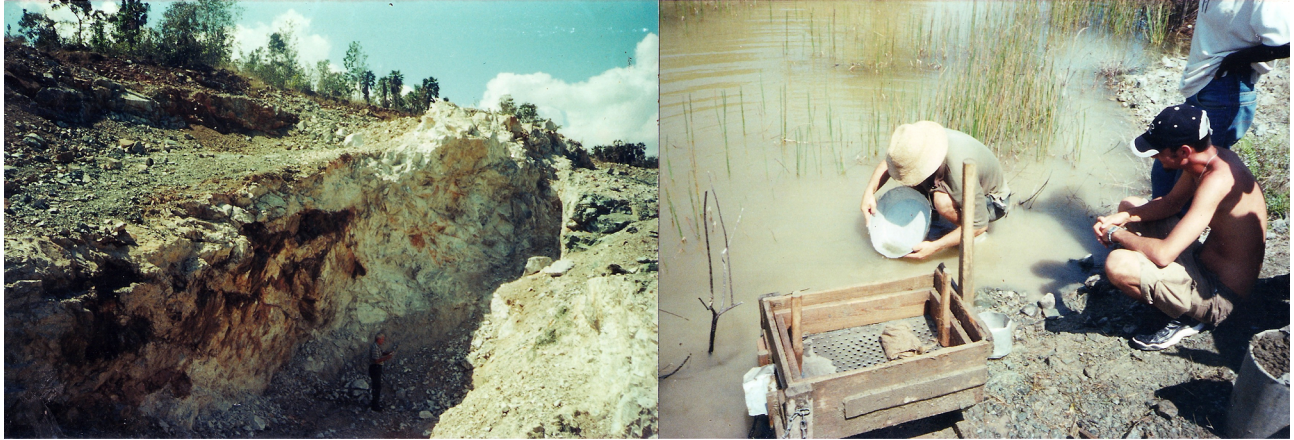
Figura 2. Bateador de la zona de Holguín. A la izquierda una trinchera de exploración del depósito Reina Victoria; a la derecha un jaguero concentrando oro a partir del lavado del escombro de las labores mineras de exploración.
