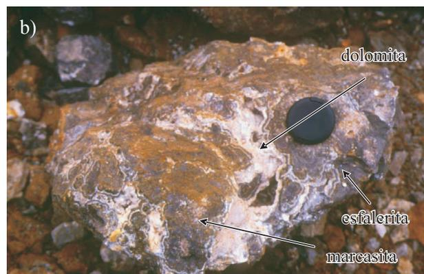
Figura 1. Fotos de texturas en depósitos MVT. a) Cristal esquelético de galena del distrito del Maestrat, Norte de la provincia de Castellón, España., visto bajo el microscopio petrográfico. b) Bandeado de dolomita, esfalerita coloforme y marcasita, en Reocín (Cantabria, N de España).
