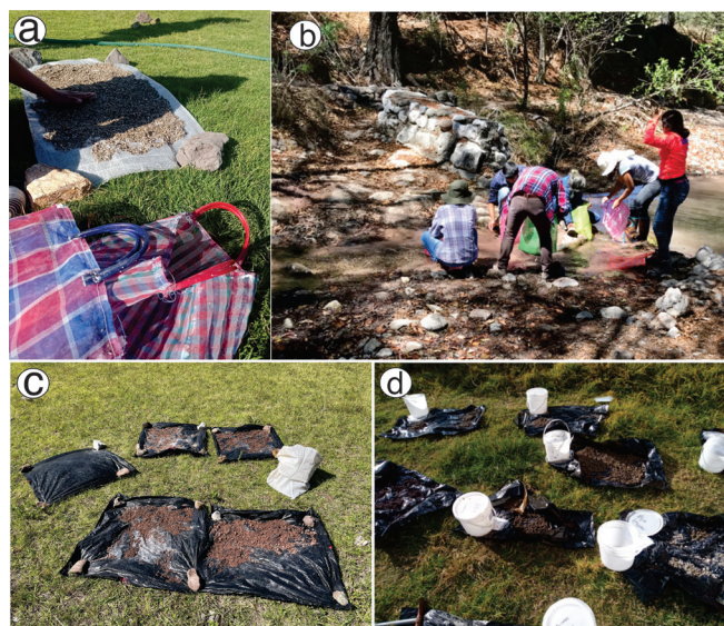
Figura 5. Tamizado en húmedo. a) bolsas de mandado con apertura de 1 mm y secado de los concentrados en campo. b) Tamizado de sedimentos en un riachuelo. c) y d) Secado de concentrados en campo con bolsas negras. También se observan las cubetas de plástico con tapa para transportar los concentrados al laboratorio.
