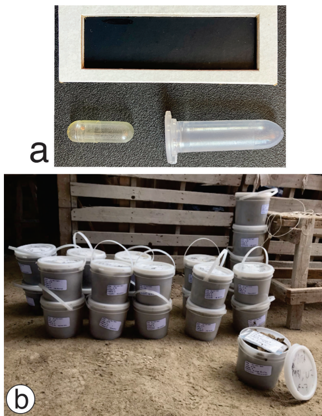
Figura 6. Elementos útiles para transportar y resguardar microfósiles en el laboratorio. a) Placa para montar microfósiles, cápsula de gelatina y tubo de microcentrifuga. b) Cubetas donde se observa el etiquetado en la tapa, en la parte externa y una etiqueta cubierta por una bolsa transparente que se coloca con el sedimento que se transporta.
